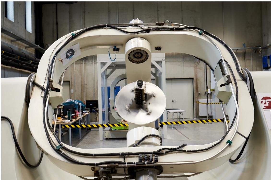
Rotation test of a NetSat on the turntable (Quelle: S<sup>4</sup> GmbH)
