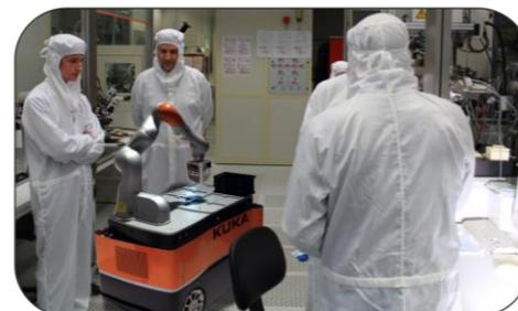
Flexibler Materialfluß zwischen Integrations- und Testbereichen durch Transportroboter
